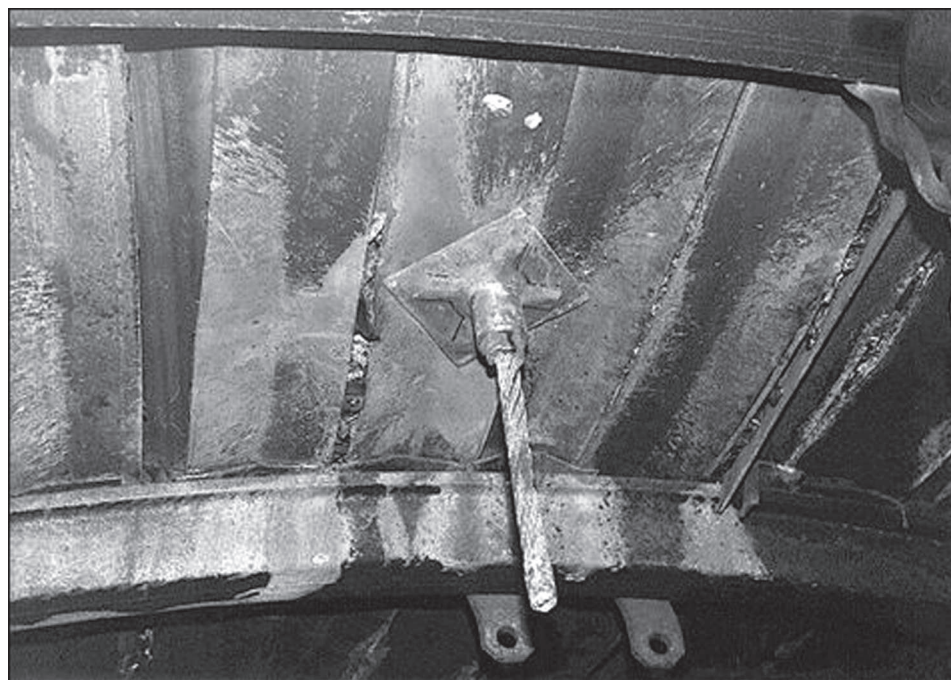
Rys. 5.4. Prawidłowo zainstalowana kotew linowa
