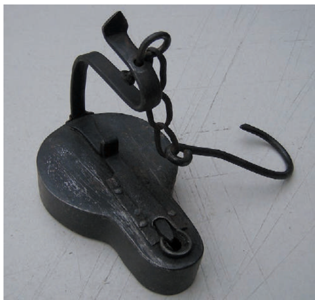
Fot. 8. Kaganek zamknięty (kopia); eksponat ze zbiorów Muzeum Górnictwa Węglowego w Zabrze
