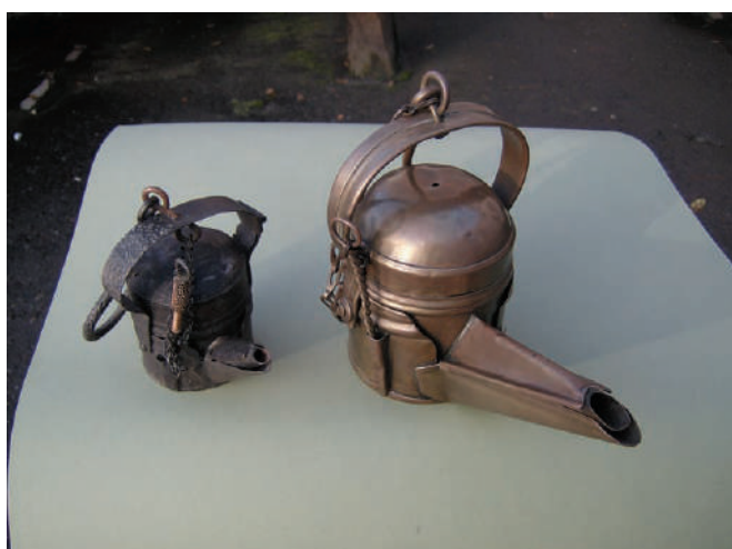
Fot. 10. Lampki olejne, tzw. olejki, mała stalowa (eksponat ze zbiorów prywatnych), duża mosiężna (eksponat ze zbiorów Muzeum Miejskiego w Zabrze)
