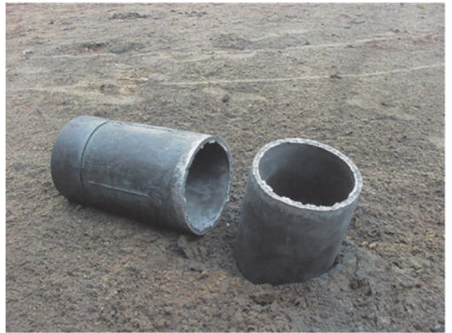
Fot. 7. Widok rury po ucięciu za pomocą ładunku kumulacyjnego
