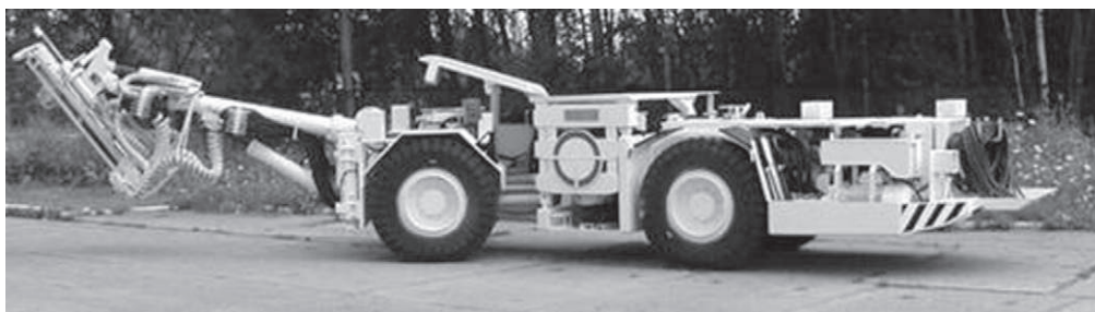
Rys. 1. Samojezdny wóz kotwiący - pomocnik operatora umieszczając ręcznie kotwie przebywa pod niezabudowanym stropem
