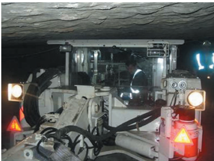
Rys. 6. Wóz kotwiący typu Roof Master 1.4A - proces zabudowy obudowy kotwiowej w Przodku o wysokości 1,6 m w Zakładach Górniczych Polkowice-Sieroszowice
