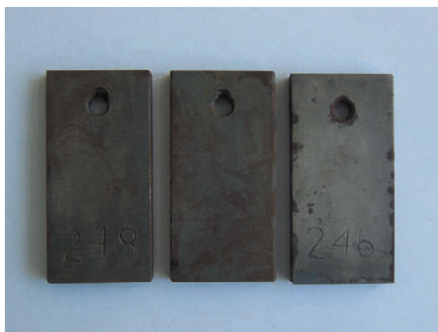
Rys. 6. Próbkę stali N-80 po testach w 80 °C z inhibitorem G
