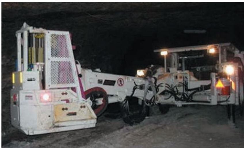
Rys. 5. Wóz kotwiący typu Roof Master 1.4A - pozycja pracy w czasie zakładania obudowy kotwiowej w Zakładach Górniczych Polkowice-Sieroszowice
