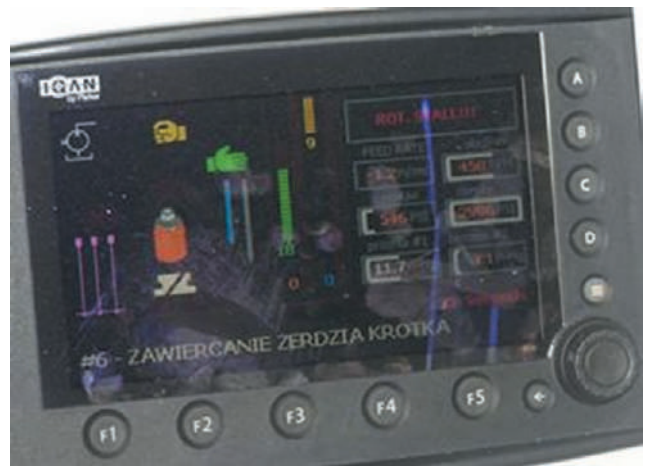
Rys. 9. Monitor komputera przedstawiający parametry pracy podczas zawierania (prędkość wiertarki, liczba obrotów/min, ciśnienie posuwu wiertarki, ciśnienie obrotów wiertarki, podciśnienie uzyskane do odsysania zwiercin z żerdzi)
