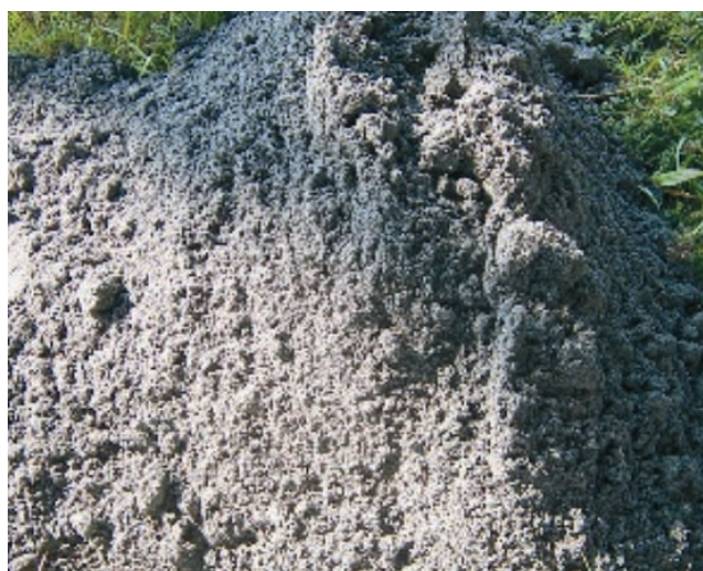
Rys. 7.6. Kruszywo skalne/kruszywo PKW odmiana 1 o frakcji 0-2 mm produkowane w ZG „Sobieski”
