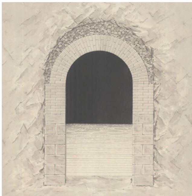
Rys. 4. Obudowa murowa sztolni z roku 1809
