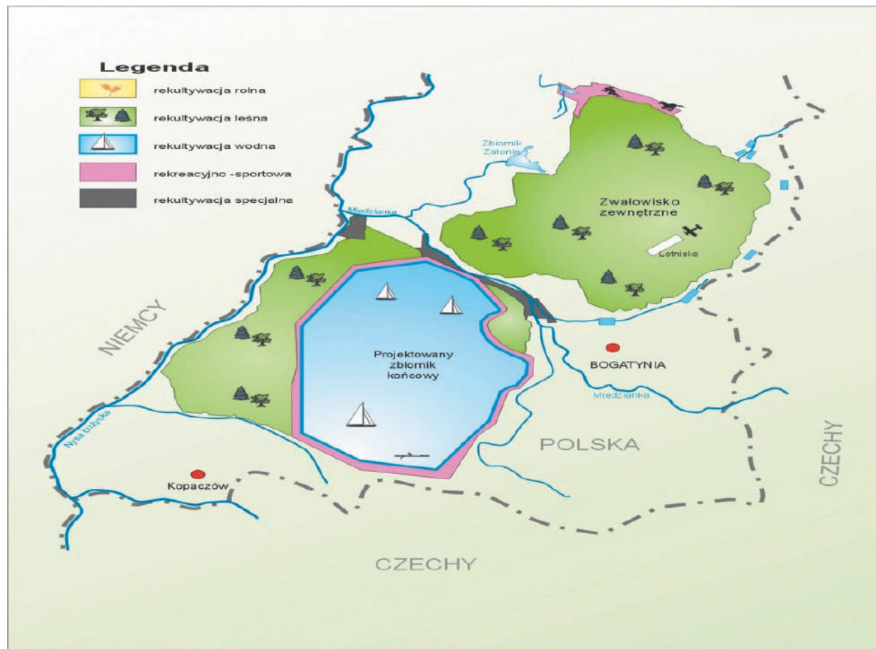
Rys. 32. Kierunki rekultywacji terenów pogórnicznych w KWB „Turów”
