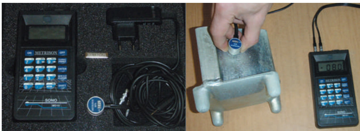
Rys. 6. Grubościomierz ultradźwiękowy typu SONO M510 firmy METRISON
