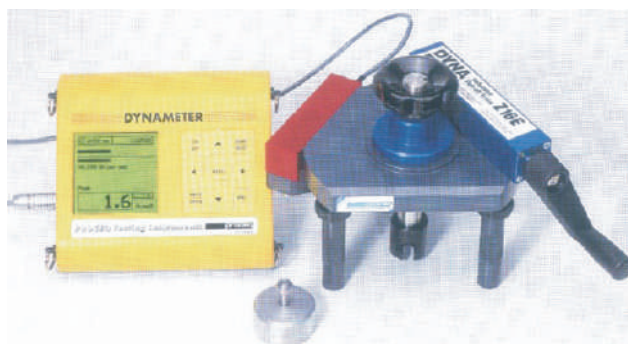
Rys. 15. „Dyna Pull-off Tester” z rejestratorem „Dynameter”
