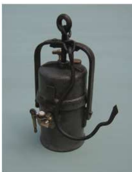
Fot. 9. Lampa górnicza stalowa z zapalniczką firmy Hermann Hesse z Norymbergi w Niemczech. Lata 30. XX wieku.
