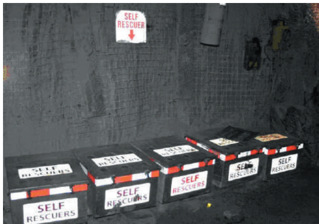
Rys. 4. Miejsce składowania pod ziemią aparatów EBA 6.5
