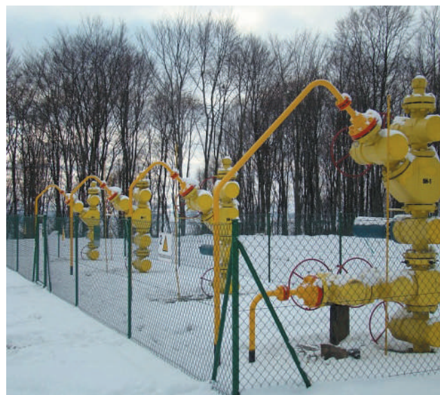
Fot. 4. Odwierty na Ośrodku Grupowym 2 podłączone do próbnej eksploatacji
