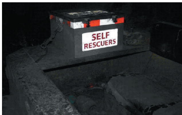
Rys. 6. Aparaty EBA 6.5 na środkach transportu górników
