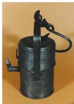
Fot. 10. Ostatni model lampy karbidowej używany na polskich kopalniach w latach 60. XX wieku
