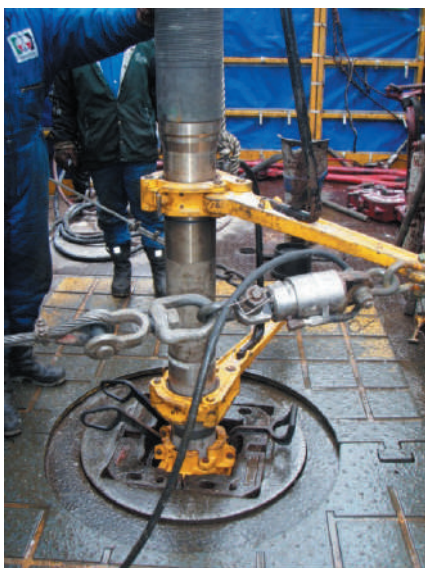
Fot. 3. Zapuszczanie uzbrojenia wgłębnego na odwiercie SH-7
