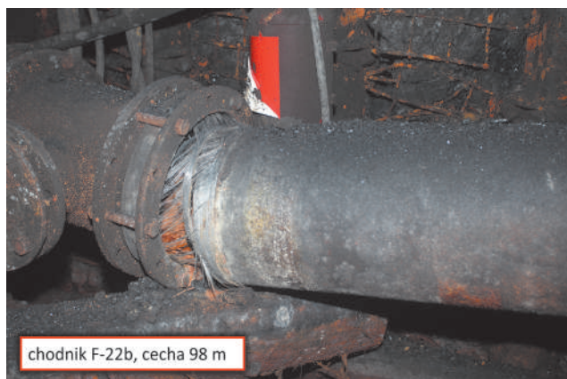
Fot. 3. Widok uszkodzonego rurociągu odmetanowania zabudowanego w chodniku F-22b
