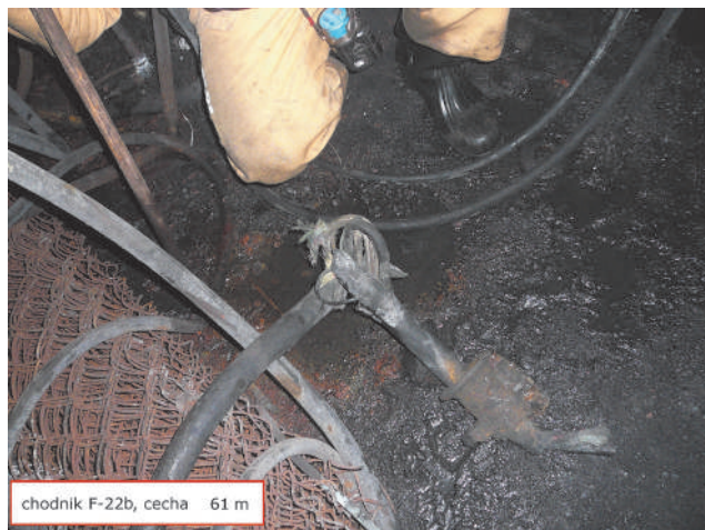
Fot. 1. Widok uszkodzonego kabla elektroenergetycznego
