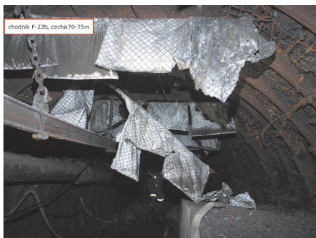
Fot. 2. Widok uszkodzonej zapory przeciwybuchowej wodnej zabudowanej w chodniku F-22b
