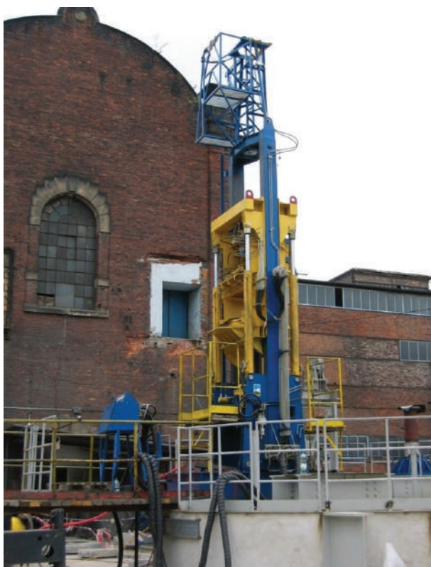
► Rys. 7. Hydrauliczny podnośnik rur HPR 1200
