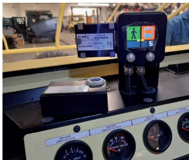
► Rys. 4. Widok urządzenia antenowego (a) oraz wyświetlacza z panelem kontrolno-sterującym i identyfikatorem aktywnym UltraTAG-B w kabinie maszyny samojezdnej w KGHM
