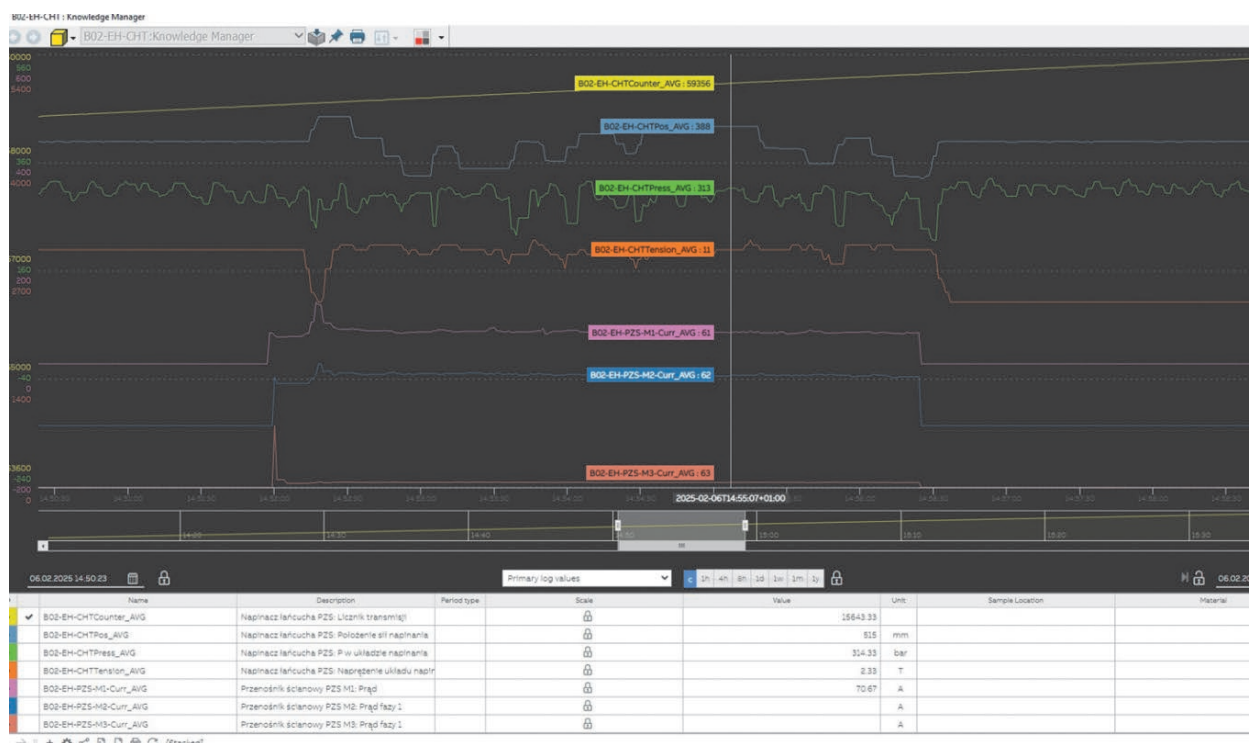
► Rys. 8. Analiza pracy układu napinania łańcucha przenośnika ścianowego w przypadku zerwania łańcucha
