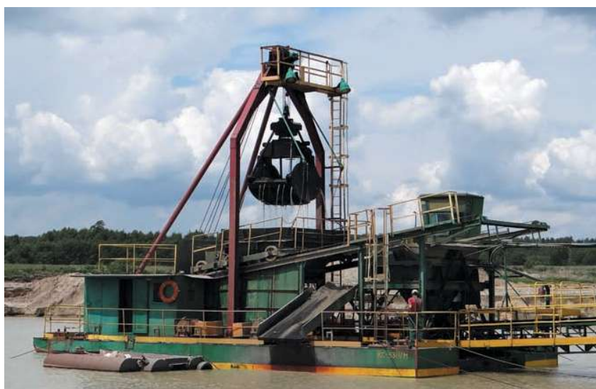
Rys. 4. Zakład Eksploatacji Kruszywa „Czarna Sędziszowska”. Wydobycie piasku i żwiru spod wody przy zastosowaniu pogłębiarki chwytkowej KG-2,5
