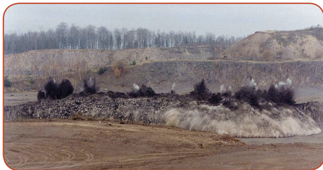
Fot. 1. Odstrzał ładunków MW z widocznym rozrzutem odłamków skalnych
