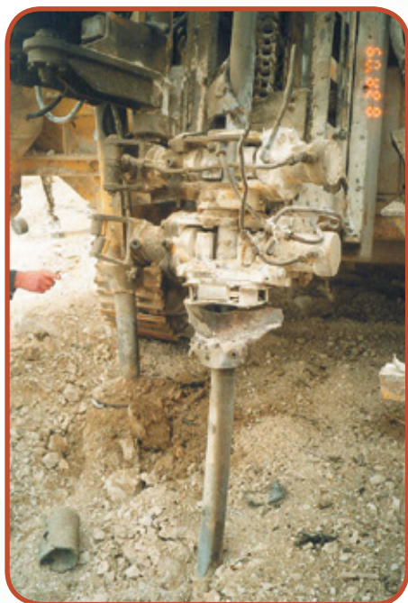
Fot. 3. Zniszczenia wiertnicy użytej do udrażniania załadowanego otworu strzałowego w Kopalni Wapienia „Morawica”
