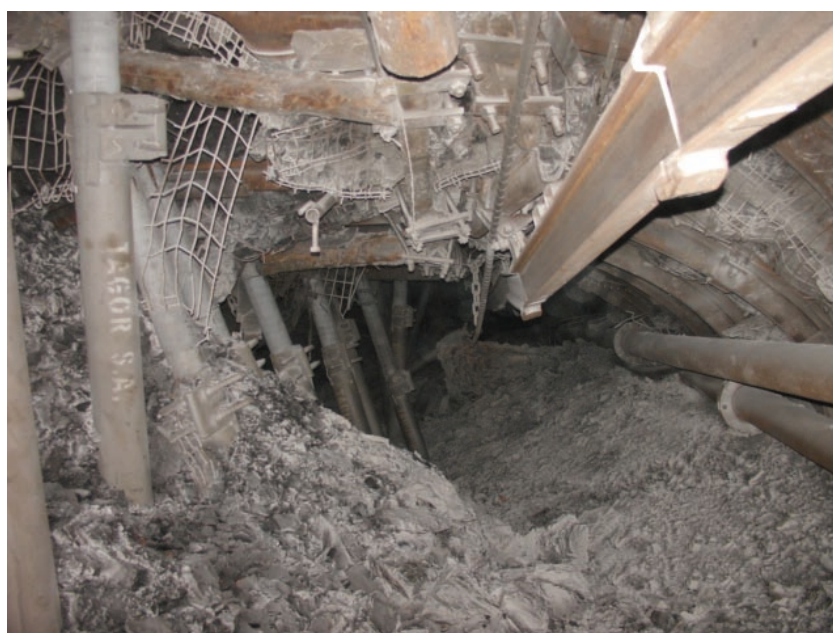
Fot. 4.1.3. Efekty tąpnięcia w rejonie eksploatowanej ściany I w pokładzie 501 w polu wschodnim na poz. 720 m w KWK „Staszic”
